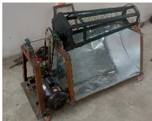
Gambar 3. Hasil rekayasa mesin pengayak cocopeat tipe rotari
