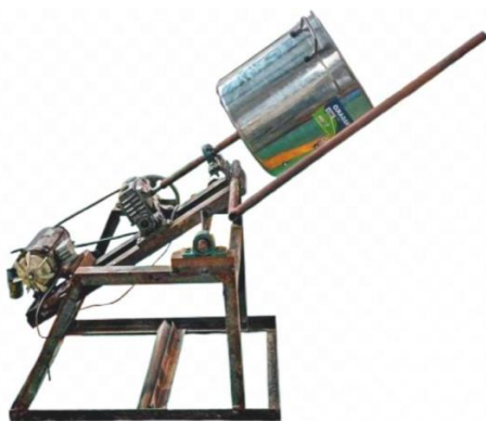
Gambar 3. Mesin pencampur bumbu hasil rekayasa
