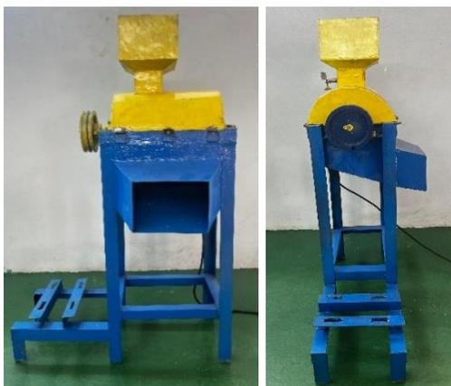
**Gambar 3.** Hasil rancang bangun mesin penghalus limbah sekam padi tanpa mekanisme penggerak
