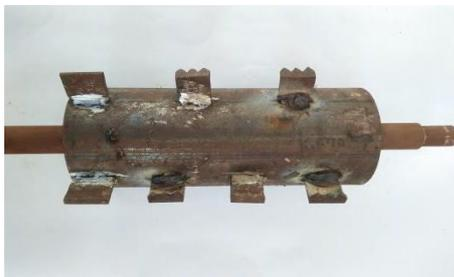
**Gambar 6.** Hasil pembuatan roll pengupas variasi I
