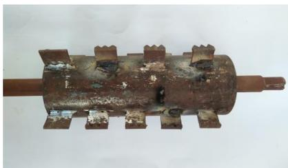
**Gambar 7.** Hasil pembuatan roll pengupas variasi II
