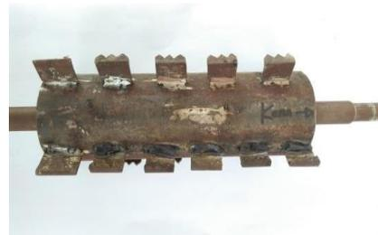
**Gambar 8.** Hasil pembuatan roll pengupas variasi III
