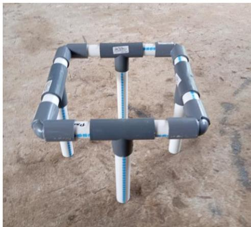
**Gambar 3.2. Desain Penyangga dari Pipa PVC**
