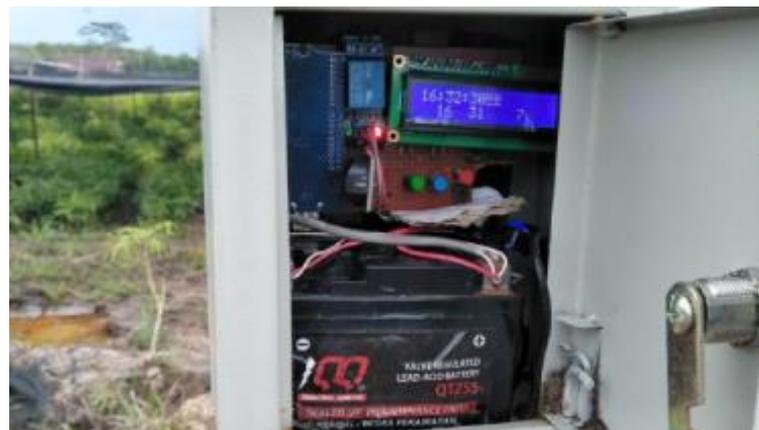
**Gambar 7. Unit Kontrol Sistem Irigasi dan Pemupukan Otomatis**
