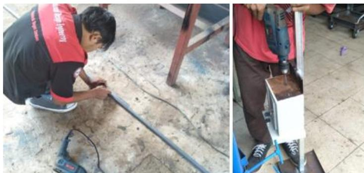
Gambar 4. Proses Pembentukan Kotak Alat Sedot Madu
