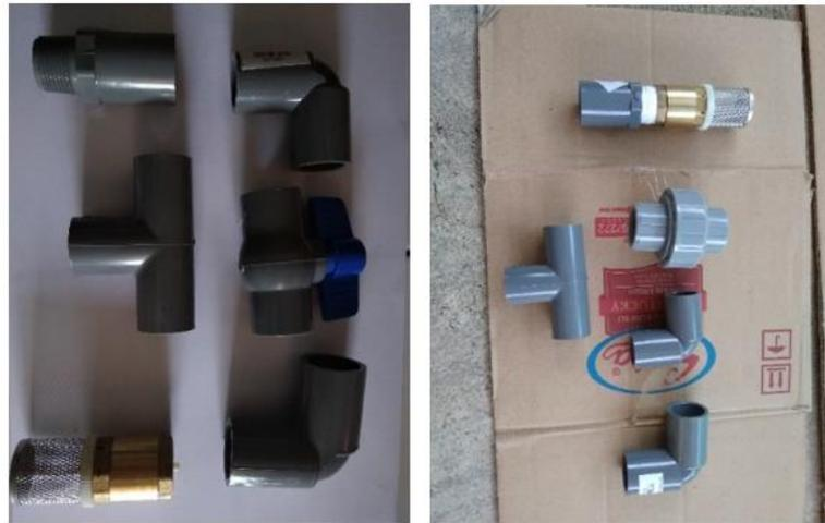
**Gambar 4. Komponen *Stop Kran*, Katup Pengisap**
