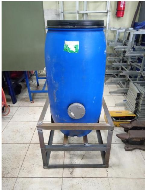
**Gambar 3.4. Komposter Anaerob dengan Dudukan Rangka Besi**
