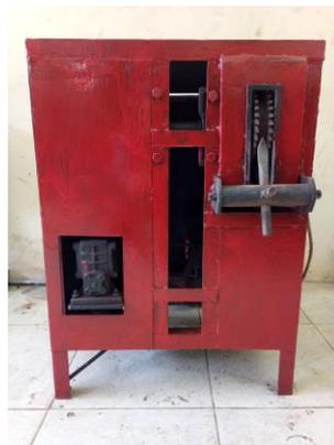
**Gambar 2. Mesin Pengupas Tempurung Kelapa Hasil Perancangan**
