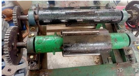
**Gambar 4.** Hasil modifikasi mesin pengupas sabut kelapa tanpa selubung
