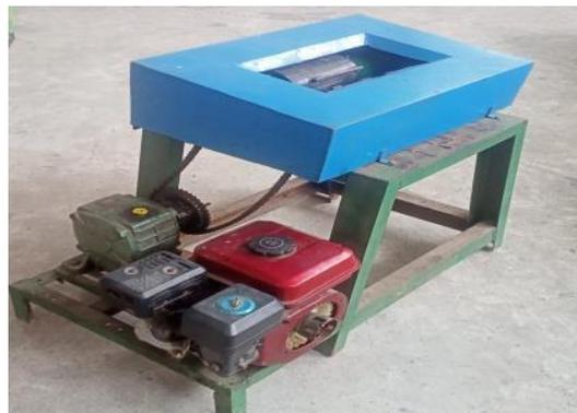
**Gambar 5.** Hasil modifikasi mesin pengupas sabut kelapa menggunakan selubung
