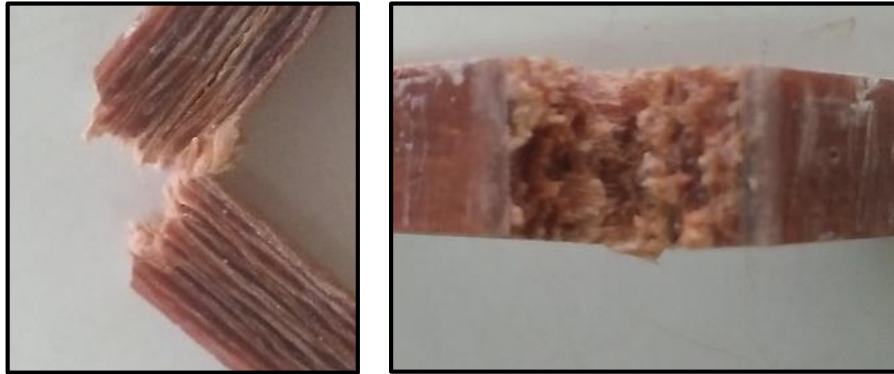
Gambar 7. Hasil patahan biokomposit kulit terap
