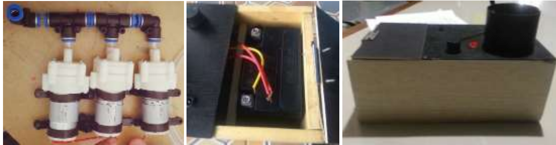
Gambar 7 Pemasangan Pompa, Baterai dan Bentuk Kotak Alat Sedot Madu
