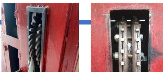
Gambar 2. Gigi pendorong (a) sebelum modifikasi, (b) setelah modifikasi
