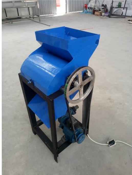
Gambar 2. Mesin pengupas kopi yang telah dibuat
