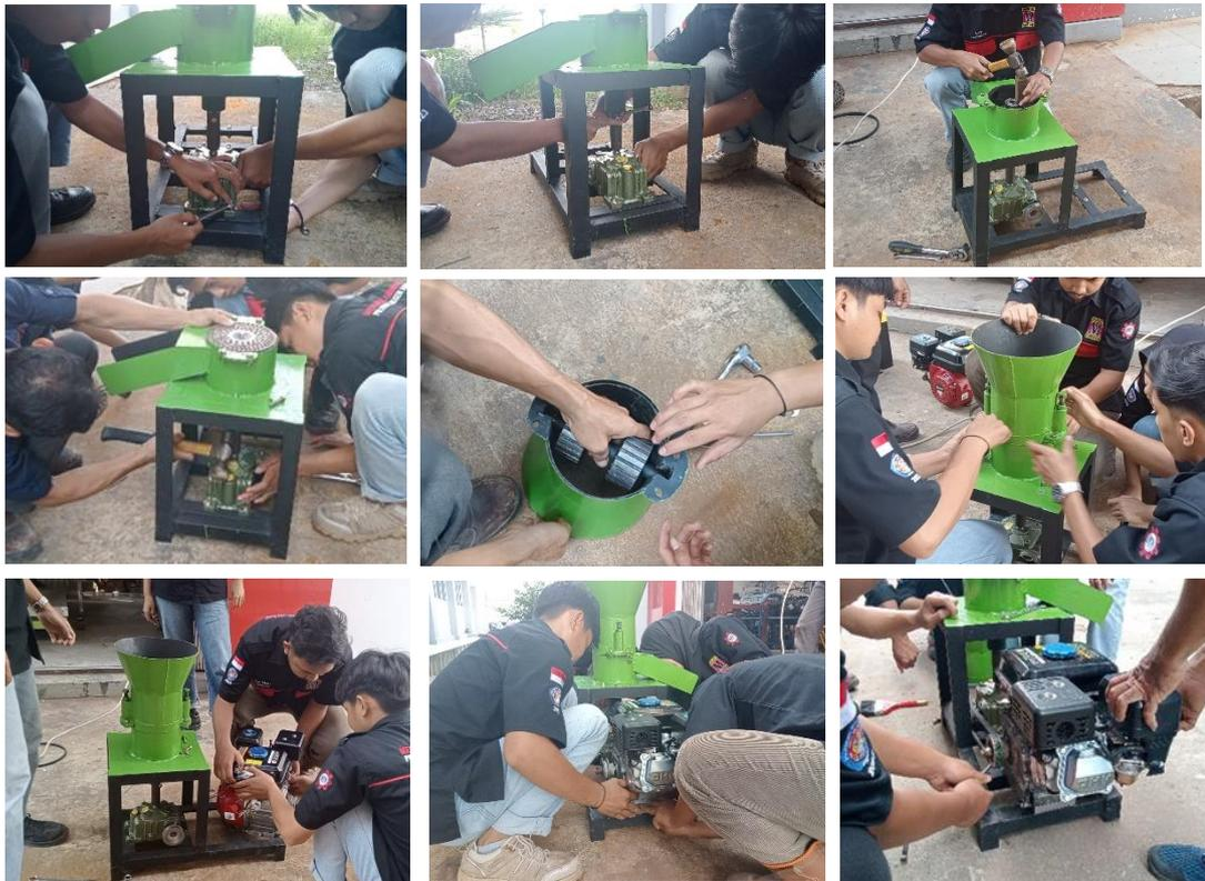
Gambar 5. Proses perakitan komponen mesin pemeras santan
