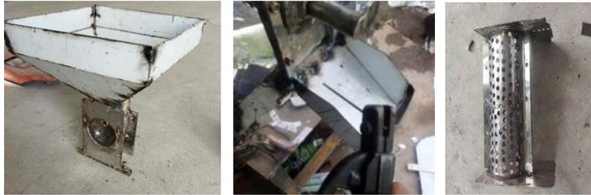
Gambar 2. Komponen mesin mesin pemeras santan
