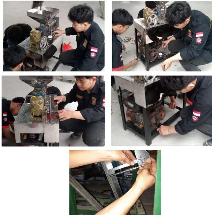
Gambar 4. Proses pemeriksaan setelah perakitan mesin
