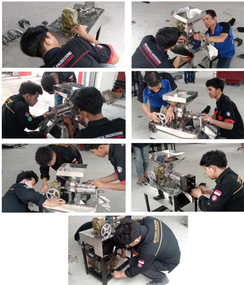
Gambar 3. Proses perakitan komponen mesin pemeras santan
