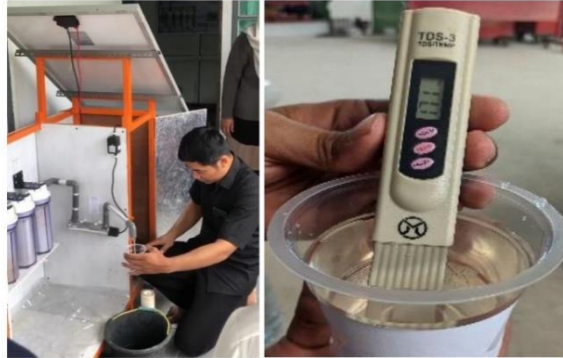
Gambar 4. Hasil Air Bersih Setelah Melalui Proses Filtrasi
