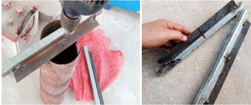
Gambar 2. Pengeboran dan pengelasan tempat dudukan kompor.
