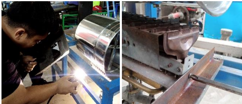
Gambar 3. Pengelasan dudukan pada rangka dan pemasangan kompor pada dudukan.
