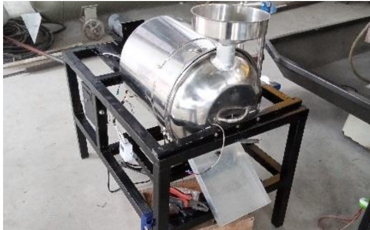
Gambar 5. Hasil rancang bangun sistem kontrol suhu pada mesin sangrai kopi.
