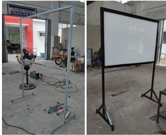
Gambar 4. Proses pembuatan dan hasil produk *White board*
