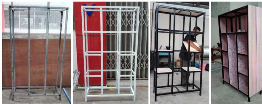
Gambar 5. Proses pembuatan dan hasil produk rak bertingkat
