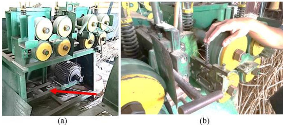
Gambar 2. (a) Komponen sistem penggerak (b) Komponen pengarah pembelah rotan
