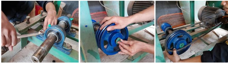
Gambar 8. Proses pemasangan bearing, poros, puli dan sabuk
