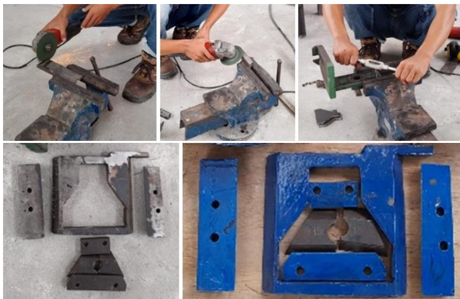
Gambar 6. Proses pengerjaan dan finishing pengarah mesin fitrit
