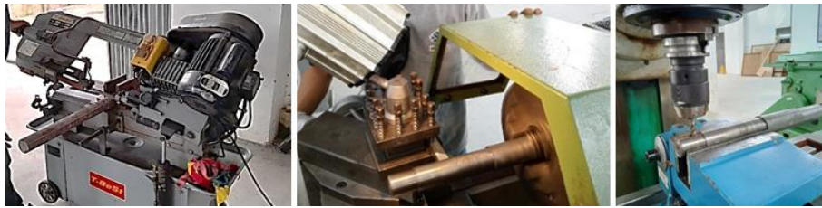
Gambar 4. Proses pembuatan poros penggerak mesin fitrit
