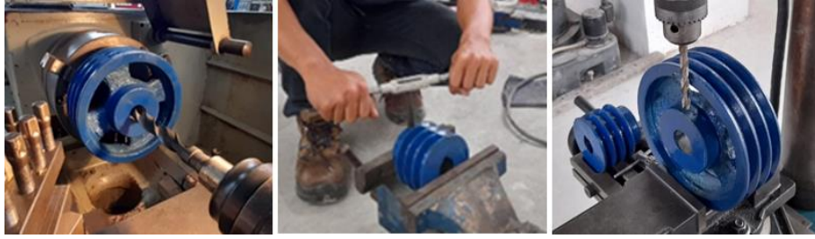
Gambar 7. Proses membuat lubang poros dan set srew pada puli
