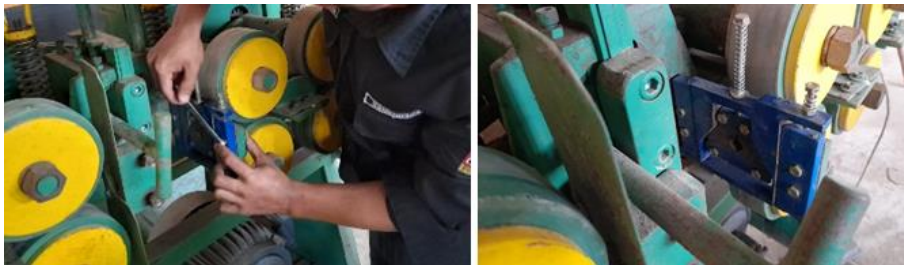
Gambar 9. Proses pemasangan komponen pengarah pembelah
