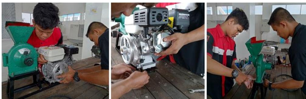
Gambar 4. Pemasangan *engine* pada mesin penggiling lada
