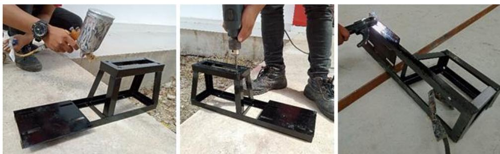
Gambar 2. Pembuatan rangka dudukan mesin
