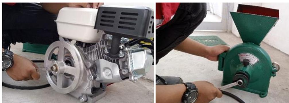
Gambar 3. Pemasangan puli pada mesin
