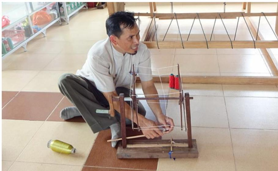
Gambar 1. Proses penggulungan benang menggunakan *terauan*
