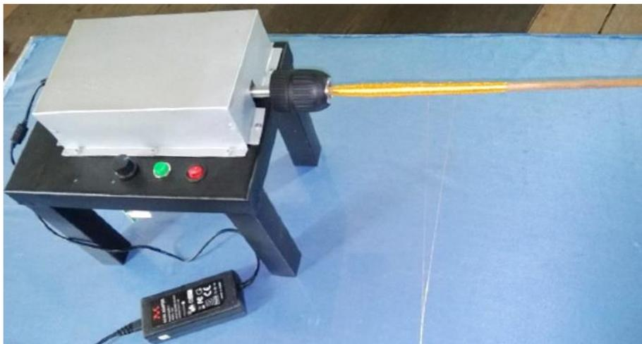
Gambar 5. Mesin penggulung benang
