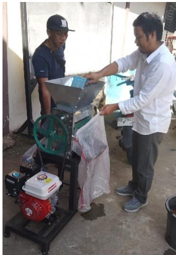
Gambar 2. Pengujian mesin pulper dengan buah kopi segar
