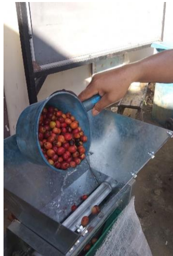
Gambar 2. Pengujian mesin pulper dengan buah kopi segar
