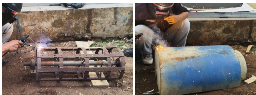
Gambar 5. Pembuatan silinder perontok dan tutup silinder perontok
