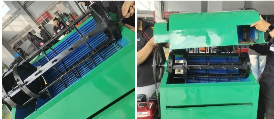
Gambar 6. Proses perakitan dan finishing mesin perontok padi.
