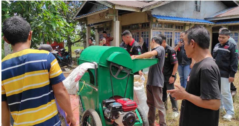
Gambar 8. Pelatihan tata cara pengoperasian mesin perontok
