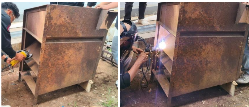
Gambar 4. Pembuatan rangka dan bodi mesin perontok
