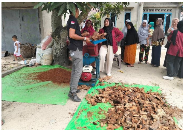
Gambar 2. Proses produksi/memasukan sabut kelapa ke mesin cocopeat
